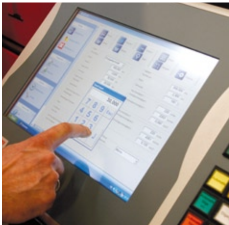
Die intuitive Menüführung über Touch-screen verlangt vom Bediener keine Spezialkenntnisse. So werden Qualität und Leistung des Säge-Zentrums von der Bedienerqualifikation abgekoppelt.
